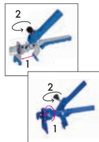
**4.** Presionar con suavidad la cuña en el interior del clip con el alicate previamente ajustado. Las piezas de cerámica se nivelarán al ejercer presión la cuña sobre las piezas contiguas, no es necesario aplicar una gran presión sobre el conjunto. Pressure the wedge gently until the tiles level. Do not over-squeeze. Tiles will level naturally when wedge is inserted firmly.
